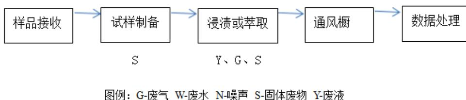
图 3.4-10 建筑管道产品二氯甲烷浸渍、交联度试验检测流程及产污节点图
