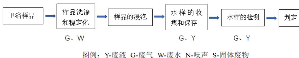
图 3.4-16 卫浴产品金属及有机污染物析出检测流程及产污节点图
