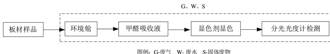
图 3.4-14 板材甲醛检测流程及产污节点图
