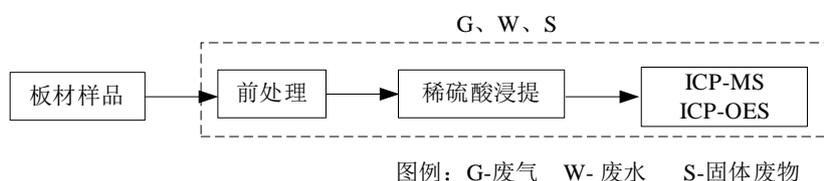
图 3.4-15 板材挥发性指标检测流程及产污节点图
