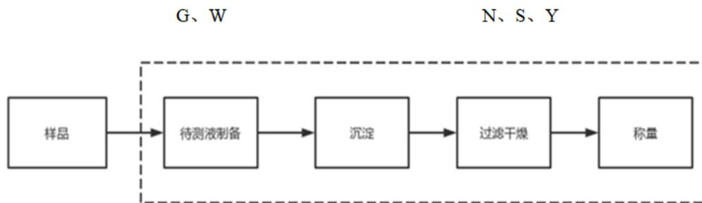
图例：G-废气 W-废水 N-噪声 S-固体废物 Y-废液
